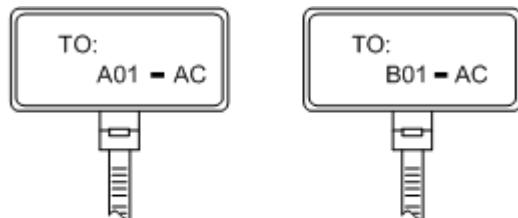
负载柜侧电缆上标签内容 电源引入侧电缆上标签内容
